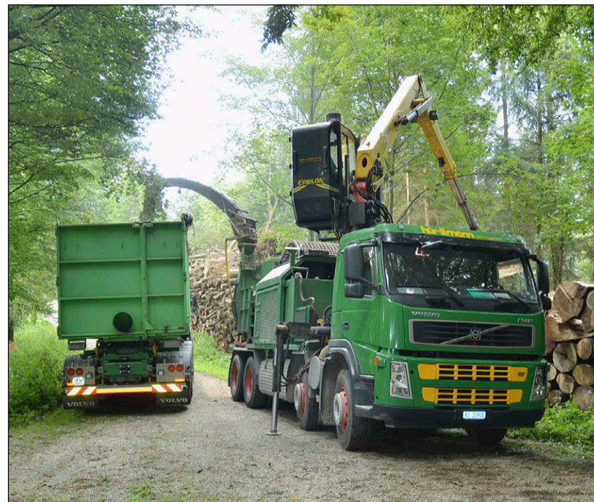
Auf dem Lastwagen rechts werden die Baumstämme zu kleinen Schnipseln geschreddert und dann in den Container links befördert.
